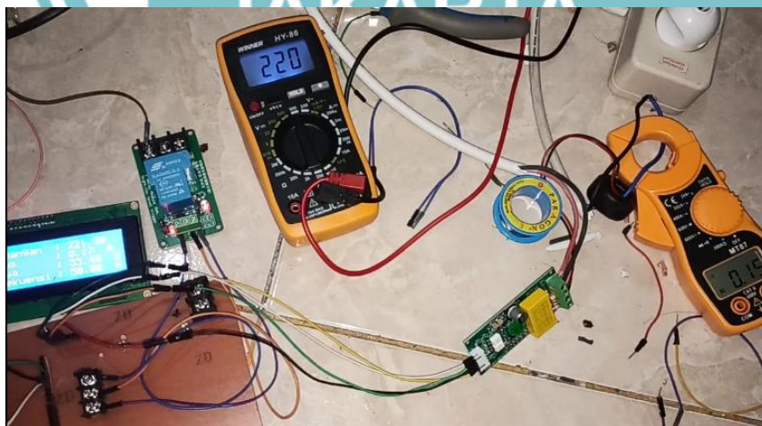
Gambar L-3 Kalibrasi Sensor PZEM 004T
