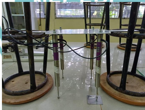
Gambar 3 Pengukuran plat besi menggunakan LVDT Displacement sensor
