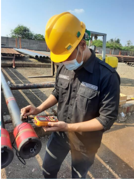
Mengukur ketebalan pada pipa menggunakan Ultrasonic Thickness Gauge
