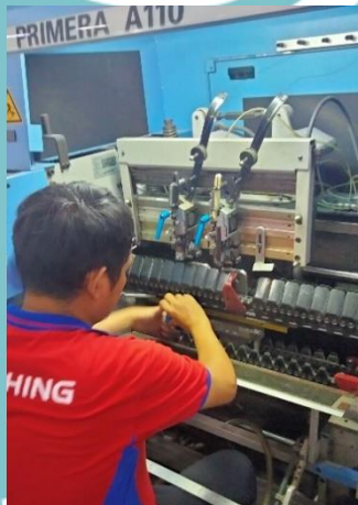
Lampiran 16 Operator sedang menyetting unit stiching
