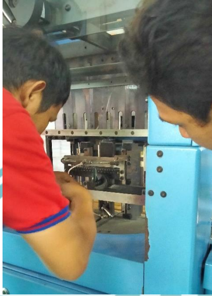
Lampiran 15 Operator sedang menyetting counter streker
