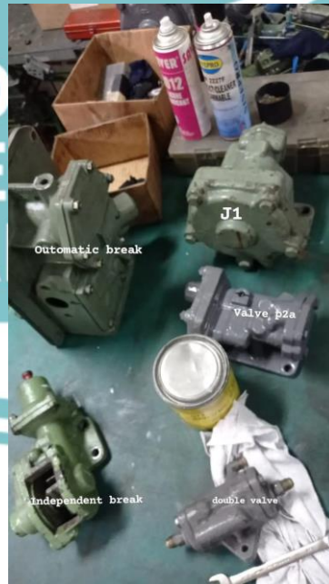
Part compressor yang akan di bongkar di lumasi white grease.
