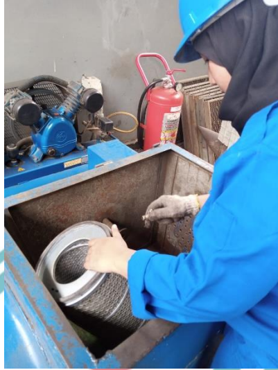
Proses pembersihan filter udara menggunakan kompresor
