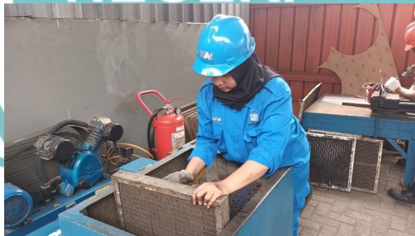
Proses pembersihan filter cabin menggunakan kompresor.
