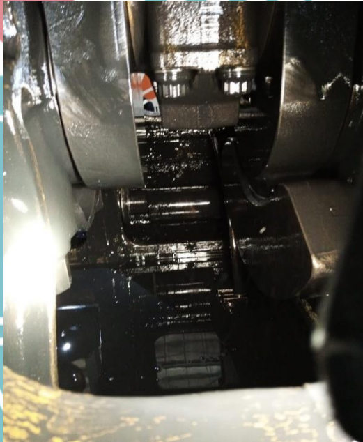
→Metal jalan yang retak dan harus diganti
