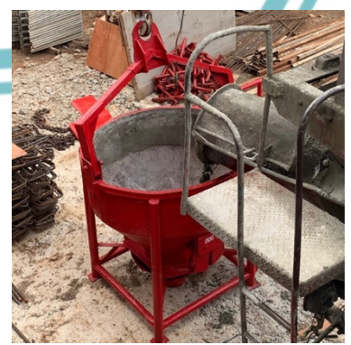
Gambar 4. 33 Concrete Bucket (Sumber : Dokumentasi Pribadi)
