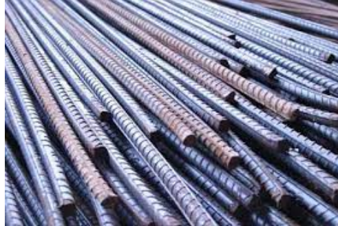
Gambar 4. 30 Baja Tulangan (Sumber : Dokumentasi Pribadi)
