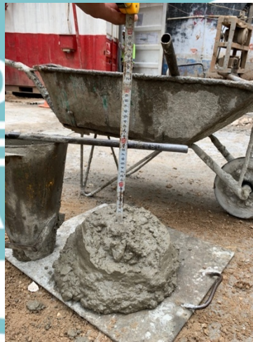
Gambar 4. 13 Tes Slump Beton Segar Pondasi Bor Pile (Sumber : Dokumentasi Pribadi)
