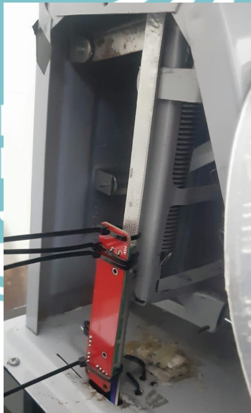
Gambar L2. 7 Pemasangan Potensiometer Slider pada Timbangan Manual
