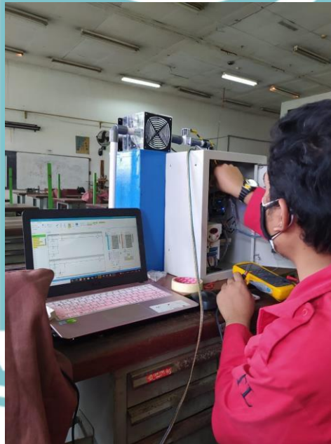
Gambar L. Pengujian dan Pengunggahan Program PLC Outseal
