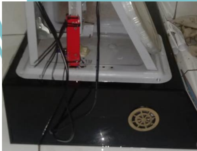
Gambar L-2. Pemasangan Potensiometer Geser Pada Timbangan Analog
