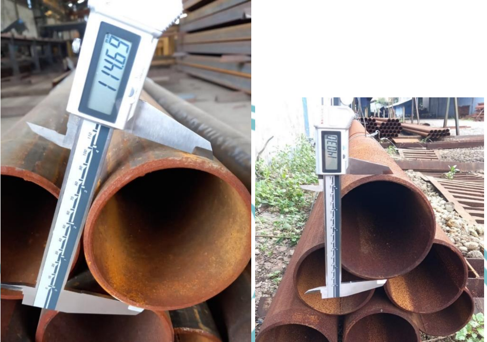
Gambar 4. 7 Pengecekan Raw Material
