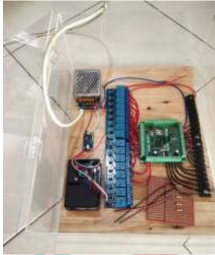
Lampiran 7 Proses Penentuan Tata letak dan Wiring Panel
