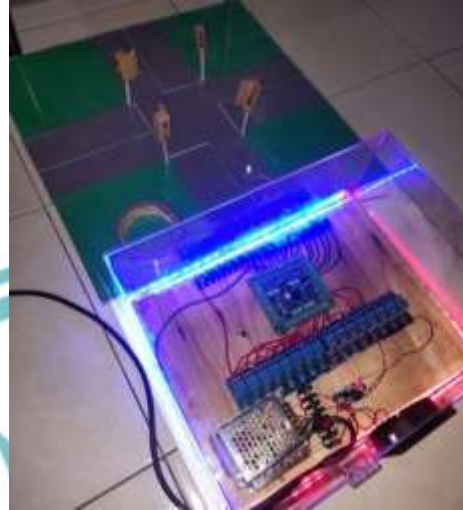
Lampiran 7 Proses Penentuan Tata letak dan Wiring Panel
