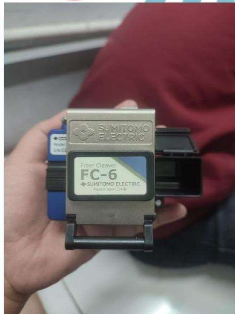
Gambar 3. 4 Pemotongan *Core*
