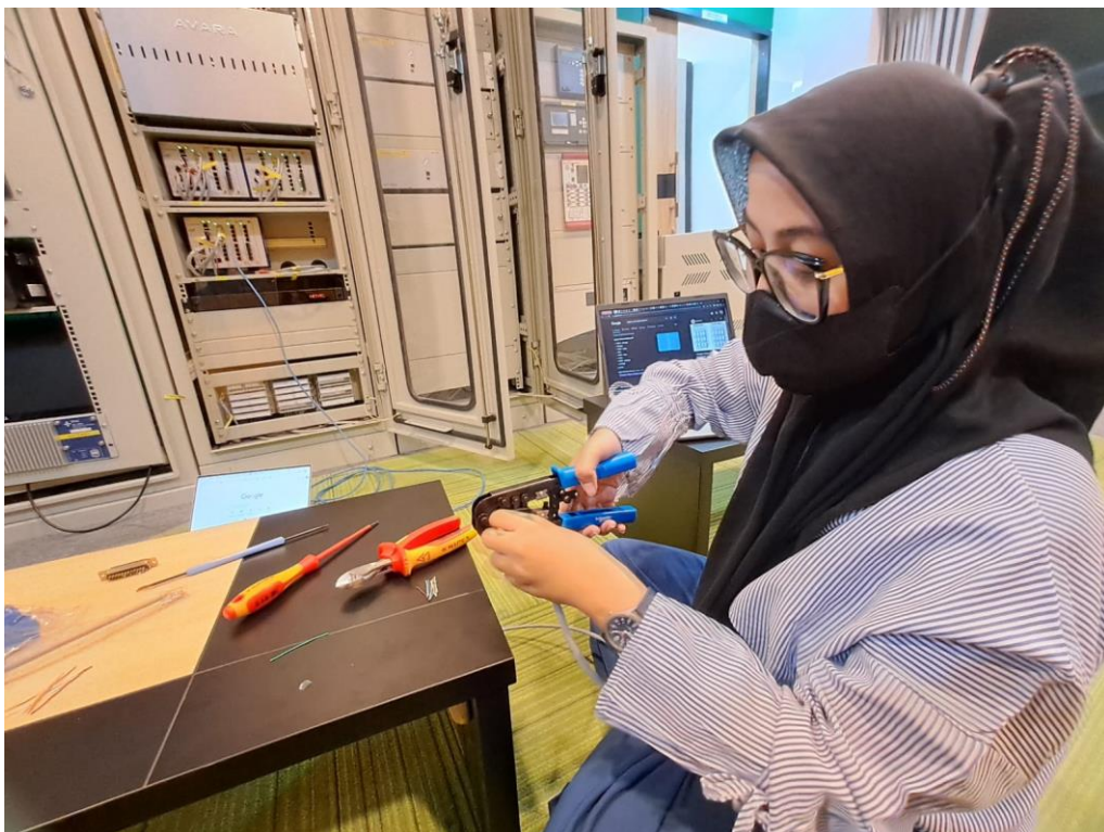
Membuat Kabel Ethernet dengan Teknik Crimping
