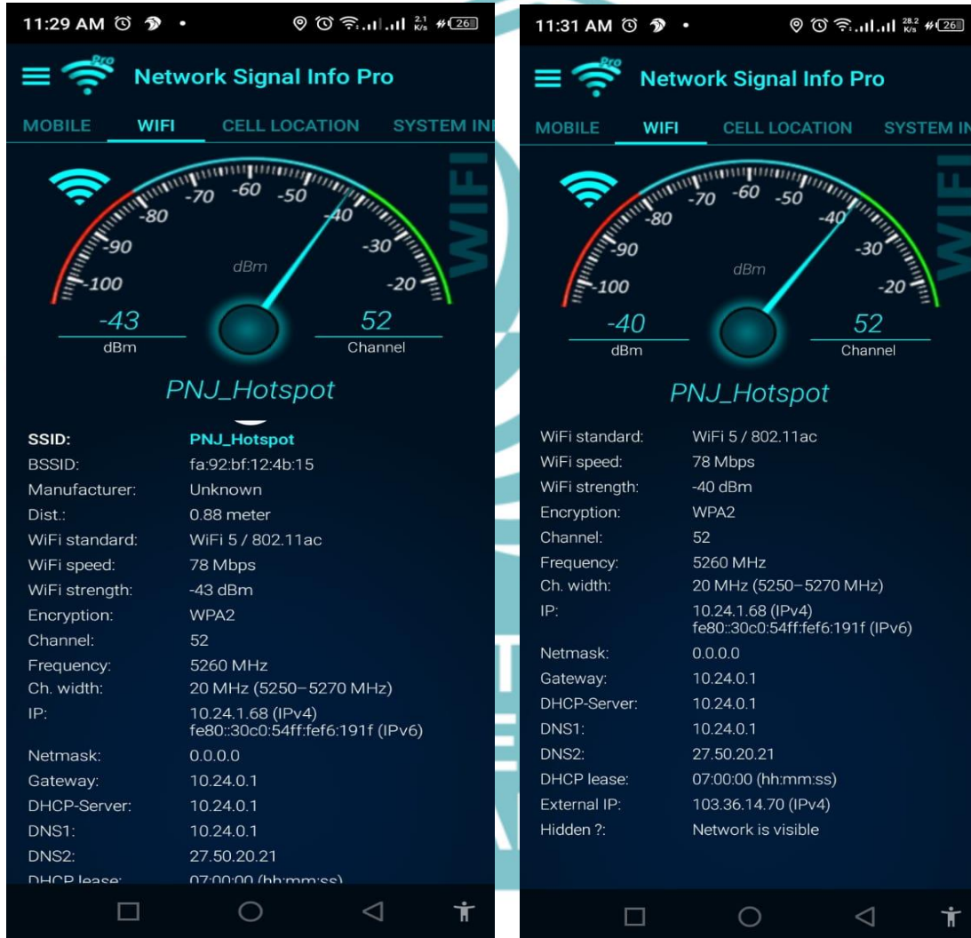
Gambar 74 : Percobaan pertama monitoring menggunakan network signal pro di ruang rapat (201)
